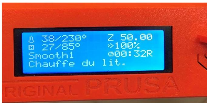
Un temps de chauffage sera nécessaire avant que l'impression ne débute. Vous pouvez suivre l'état des températures sur l'écran même de l'imprimante.
